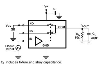
FIGURE 3B. TEST CIRCUIT
