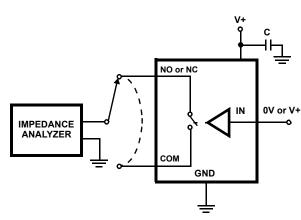
FIGURE 7. CAPACITANCE TEST CIRCUIT
