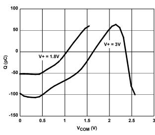
FIGURE 12. CHARGE INJECTION vs SWITCH VOLTAGE
