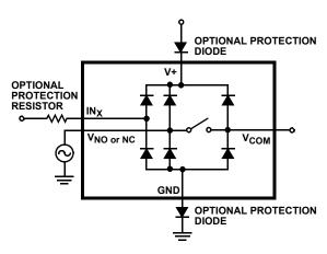
FIGURE 8. OVERVOLTAGE PROTECTION
