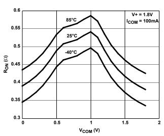
FIGURE 11. ON RESISTANCE vs SWITCH VOLTAGE
