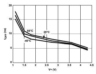
FIGURE 14. TURN-OFF TIME vs SUPPLY VOLTAGE
