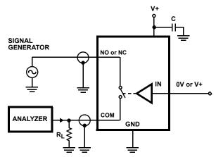
FIGURE 4. OFF ISOLATION TEST CIRCUIT
