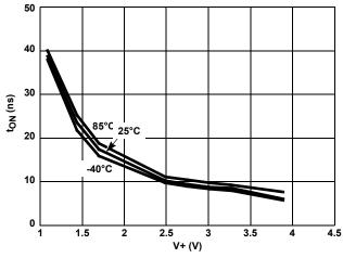
FIGURE 13. TURN-ON TIME vs SUPPLY VOLTAGE
