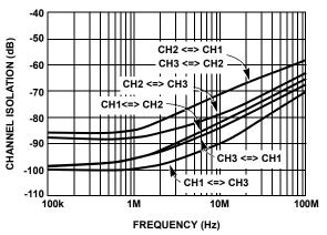
FIGURE 9. CHANNEL ISOLATION vs FREQUENCY
