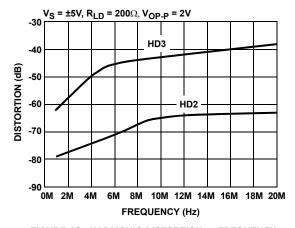
FIGURE 12. HARMONIC DISTORTION vs FREQUENCY
