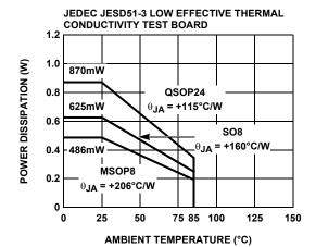
FIGURE 18. PACKAGE POWER DISSIPATION VS AMBIENT TEMPERATURE
