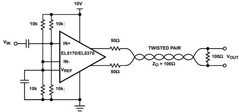
FIGURE 22. SINGLE SUPPLY TWISTED PAIR DRIVER
