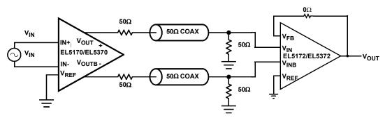
FIGURE 21. DUAL COAXIAL CABLE DRIVER
