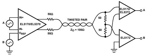
FIGURE 23. DUAL SIGNAL TRANSMISSION CIRCUIT
